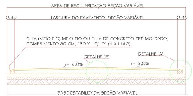
SEÇÃO TRANSVERSAL PAVIMENTO TIPO PAVERS - PRAÇA DAS MERCÊS SEM ESCALA
