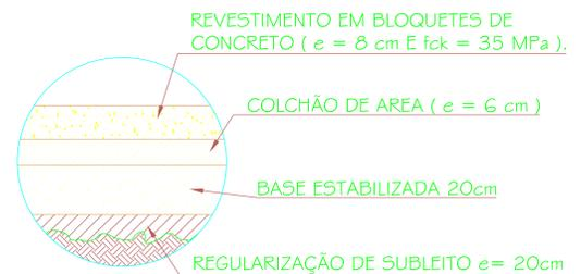
DETALHE "B" CAMADAS DA PAVIMENTAÇÃO SEM ESCALA
